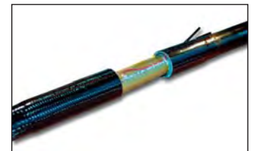
PICMA Aktor in CFK Struktur
