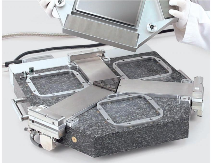
Die 6-achsige Bewegung wird über einen 6D-Sensor geregelt. Die Referenzfläche für die Sensorik befindet sich mittig unterhalb des magnetisch schwebenden Läufers.
