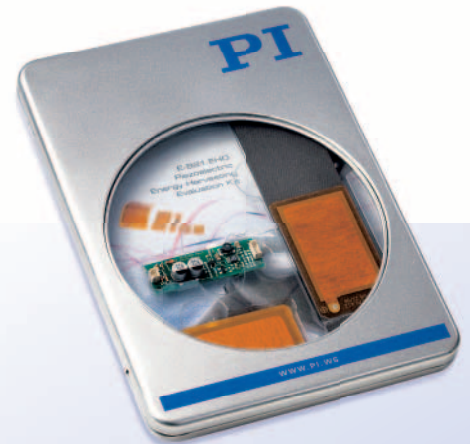
Das Evaluierungsset E-821.EHD enthält zusätzlich zum Piezoelement bereits passende Wandler- und Speicherelektronik.
