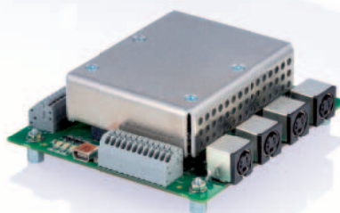
E-870.10: Steck- bzw. lötpbarer einkanaliger Treiber für PIShift Piezoträgheitsantriebe
