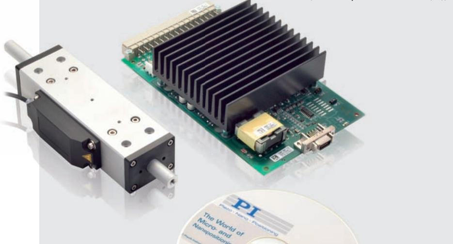
Speziell im Hinblick auf die Anforderungen moderner Automatisierungstechnik, hat PI einen skalierbaren piezobasierten Linearantrieb entwickelt, der sich mit Antriebskräften bis 10 N, Geschwindigkeiten bis 0,5 m/s und Stellwegen im Bereich mehrerer 10 mm für viele Applikationen eignet. Als Antrieb dient ein
